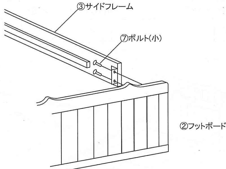
図のよう、⑦ボルト(小)を③サイドフレームの金具に通し仮締めします。
